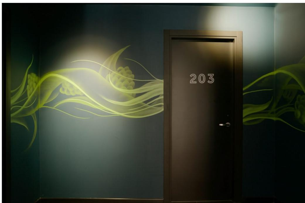
L'azienda ha fornito **porte lisce** in finitura laccato nero opaco, certificate EI60 come da normativa UNI EN 1634 con abbattimento acustico a 44 decibel, serratura elettronica e chiudiporta esterno. Per completare la fornitura con la stessa estetica, sono state realizzate anche le porte dei bagni e degli spazi comuni.
